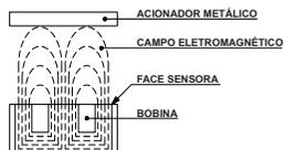
A bobina faz parte de um circuito oscilador que em condição normal (desacionada) gera um sinal senoidal. Quando um metal aproxima-se do campo, este por correntes de superfície (Foucault), absorve a energia do campo, diminuindo a amplitude do sinal gerado no oscilador.
