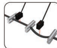
Controle de loop de extrusão de borracha
